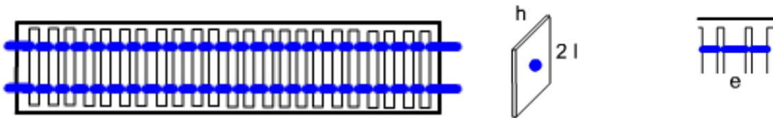
Le diamètre des tubes est de 15 mm, et leur épaisseur de 1,5 mm. L'espacement entre les ailettes est de 3 mm.
